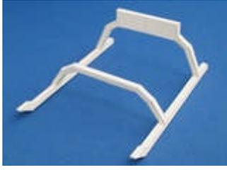
スキッドチューブにクロスチューブをそれぞれ差し込み接着。ランディングギアを組み上げる。
