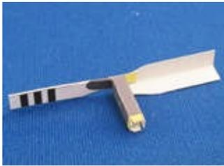
テールロータードライブを組みテールローターではさみ込むようにテールローターを組み上げる。
