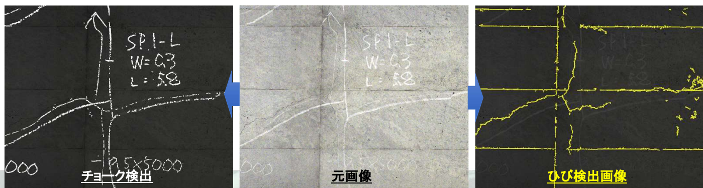
8Kカメラ画像解析模様 (左:チョーク検出画像、中央:元画像、右:ひび検出画像)
